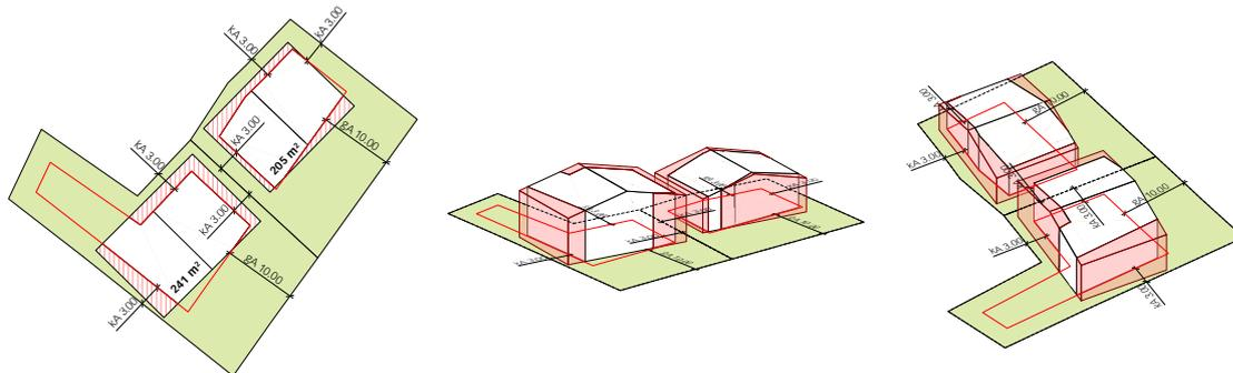
Abb. 2 Beispielsskizze einer bestehenden Bebauung in der Kernzone. Rot eingefärbt sind Gebäudeteile, welche die heute geltenden Grenzabstände überschreiten und somit unter die Besitzstandsgarantie fallen.
